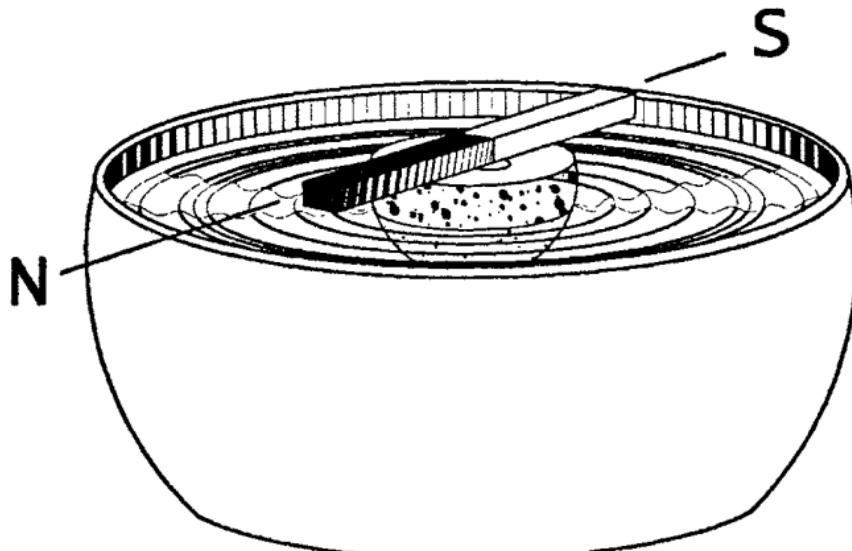
*Если магнит положить на кусок пенопласта, плавающий в тазу, то магнит повернется так, что его концы будут указывать на север и юг*
