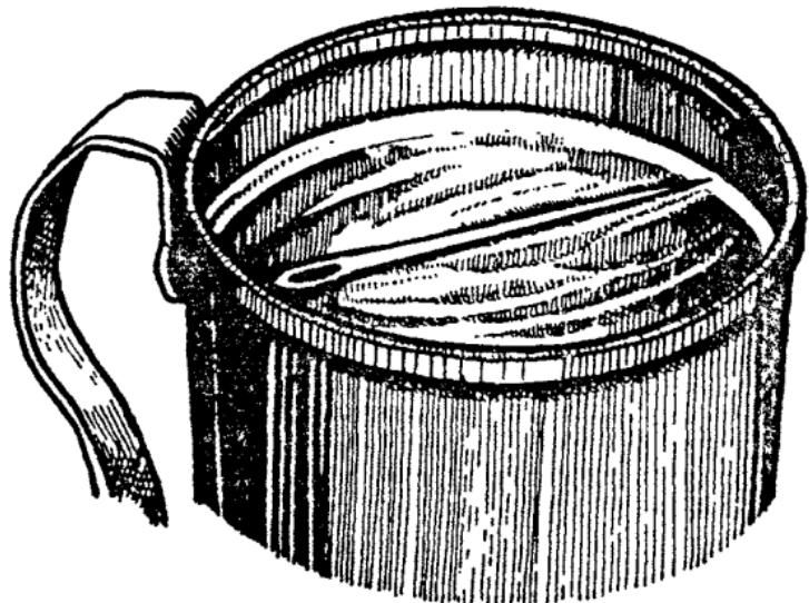
*Сила, удерживающая иголку на поверхности воды, называется силой поверхностного натяжения*
