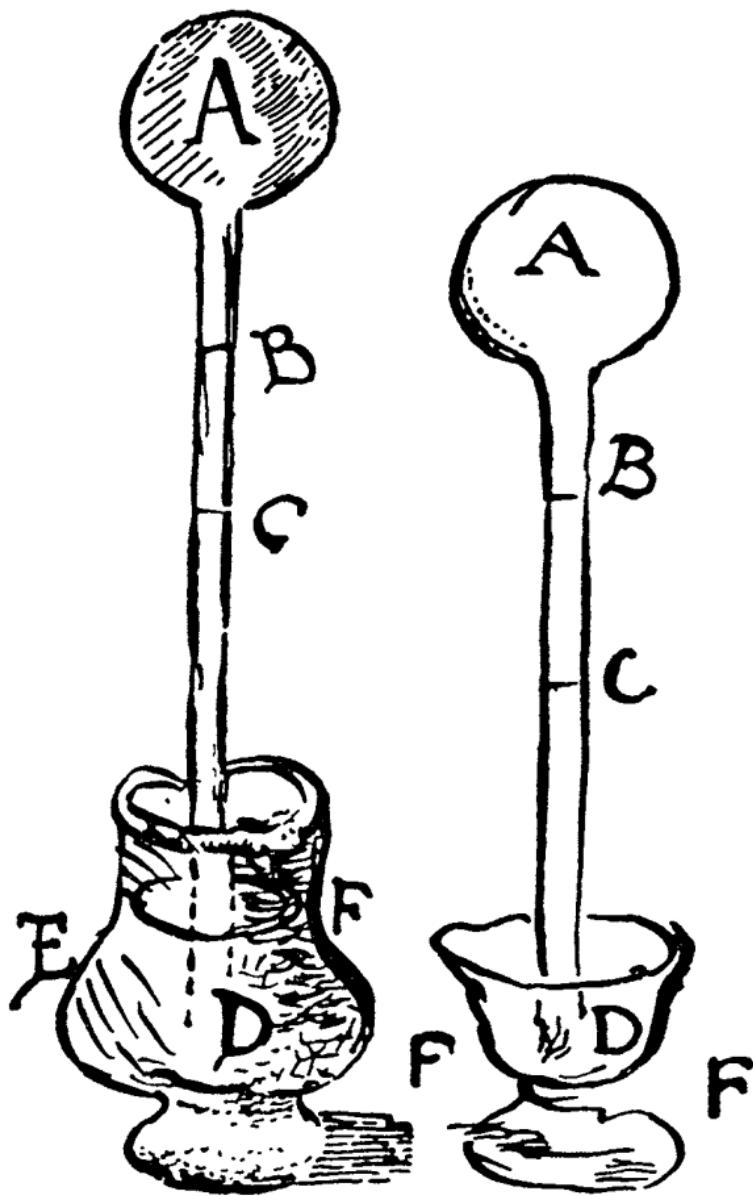
*Термометр Галилея. Рисунок из рукописи*
