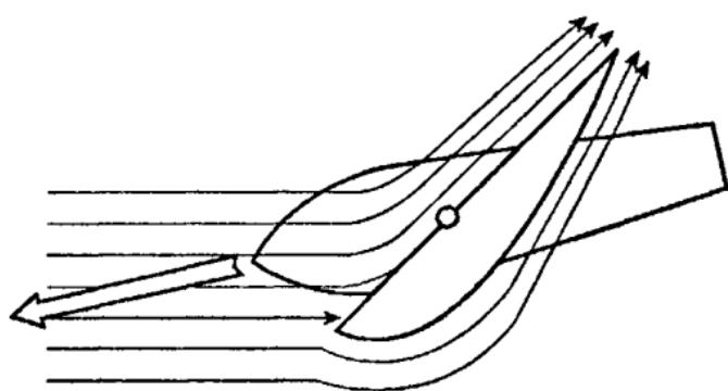
*Схема движения яхты против ветра*
