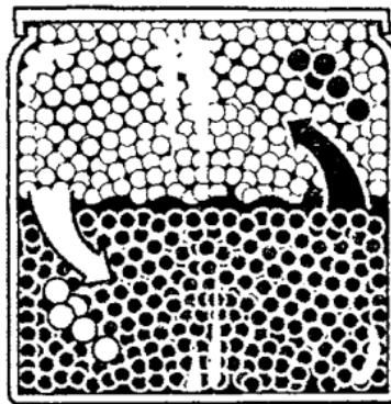
*Жидкость испаряется благодаря тому, что некоторые молекулы могут оторваться от ее поверхности. Нагретая жидкость испаряется быстрее холодной*
