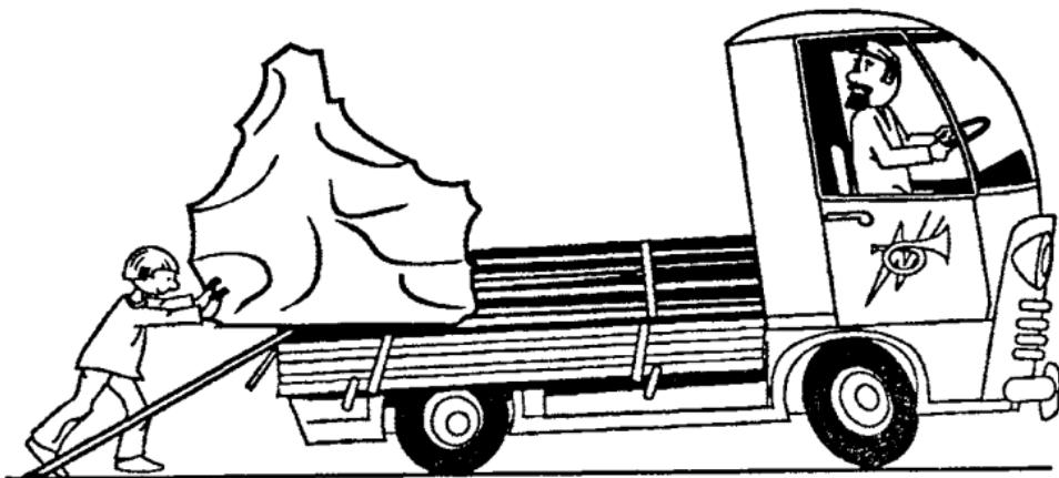
Если совместить две наклонные плоскости, то получится клин. Для того чтобы поднять ту же ледяную глыбу на высоту борта грузовика, мы можем, не передвигая ее, забить под нее постепенно расширяющийся деревянный брускок, который называют клин. Клин удобно использовать для того, чтобы расколоть узловатое полено, и так действительно делают, когда колют дрова. Клин используется в плуге, который входит в землю, клин — это острие ножа, бритвы и других режущих инструментов.
