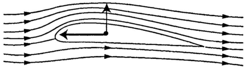
*Схема обтекания воздухом крыла самолета*
